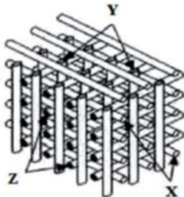
Fig. 2 Uniaxial NOOBED orthogonal structure<sup>[3]</sup>
