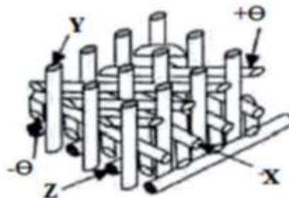
Fig. 3 Multi axial NOOBED orthogonal structure<sup>[3]</sup>
